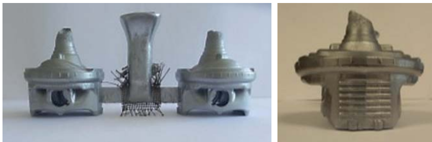
Obr. 9 Odlitek pístů s vtokovou soustavou (vlevo), odlitek pístu z boku (vpravo)
