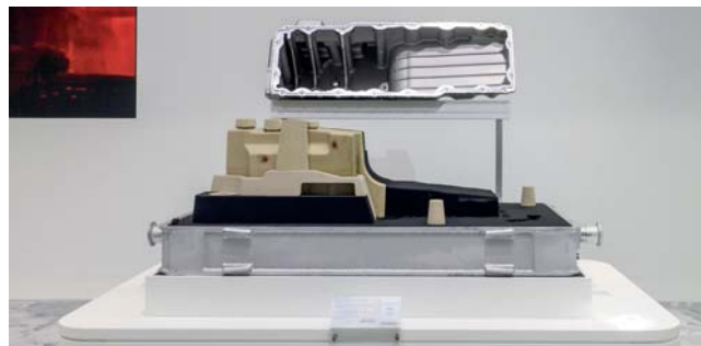
Obr. 7 Forma vyrobená z MAGNASETU 2.0 – nové netoxické furanové pryskyřice šetrné k pracovnímu prostředí. Zobrazený odlitek je olejová vana pro užitková vozidla.
