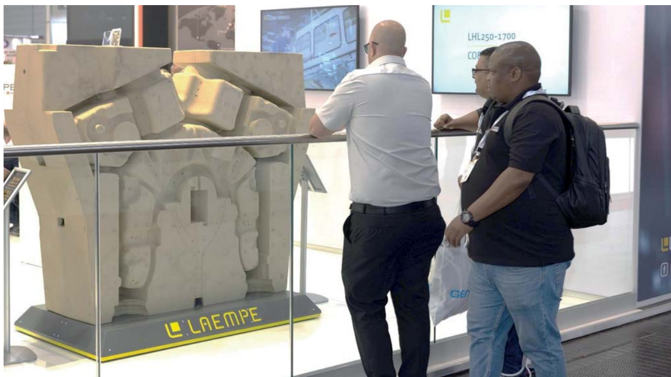
Obr. 1 Jádro vyrobené na největším vstřelovacím stroji na světě LHL250-1700, foto Kubelková
