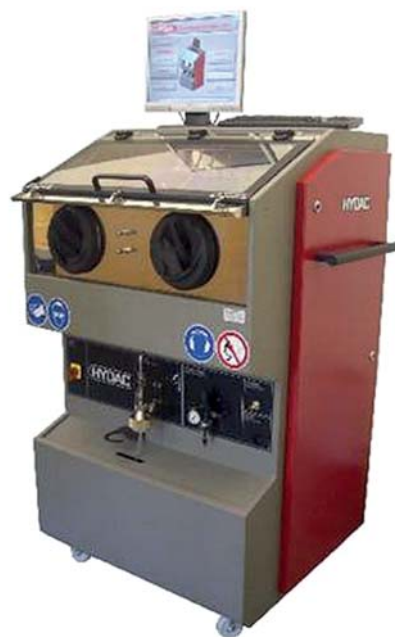
Obr. 4.1. Přístroj CTU pro vyhodnocení zbytkových nečistot na obrobcích
