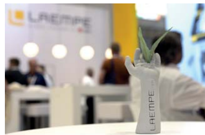
Obr. 2 Jádro vyrobené na 3D tiskárně Laempe, foto Kubelková
