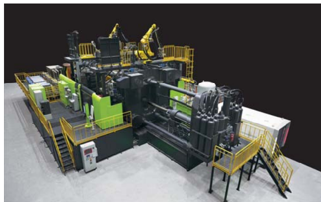
Obr. 1 Tlakový lící stroj LEAP s uzavírací silou 90.000 kN pro výrobu odlitků velkých rozměrů
