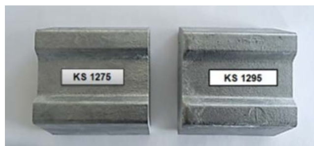
Obr. 1 Části housek slitin hliníku KS 1275 a KS 1295 pro výrobu pístů spalovacích motorů
