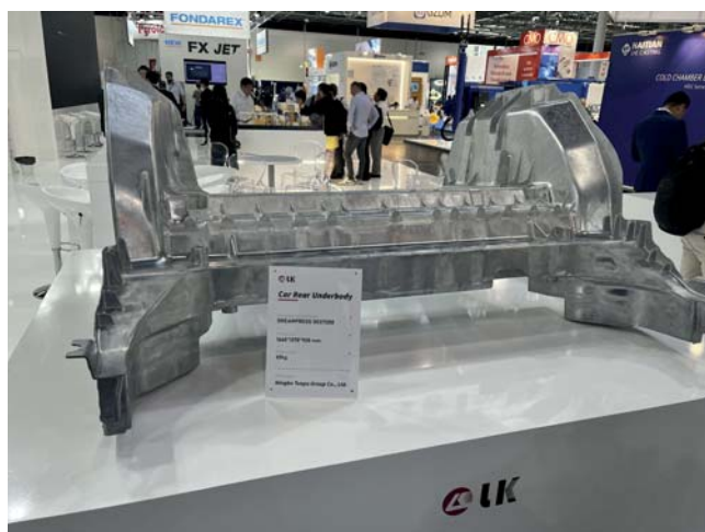
Obr. 1 1660 x 1370 x 920 mm, 65 kg, zadní část automobilového skeletu
