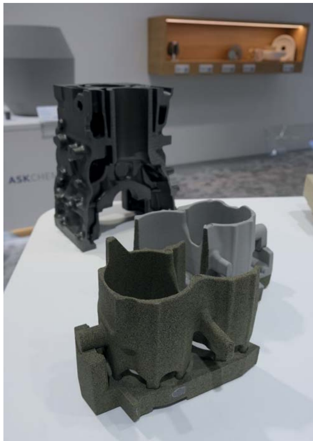
Obr. 4 ASKURAN 3D – Nová technologie bez obsahu bisfenolu A umožňuje uživatelům přejít na bezpečný systém furanových pryskyřic, aniž by došlo ke snížení kvality procesu nebo odlitků.
